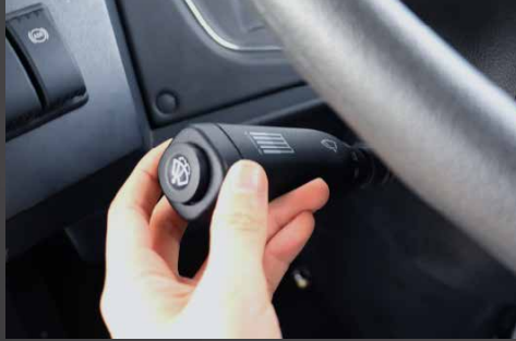
4段階回生ブレーキ
