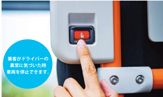
ドライバー異常時対応システム（EDSS：Emergency Driving Stop System）
