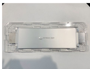
急速充電パックに用いる VDA355 規格のセルとモジュール
