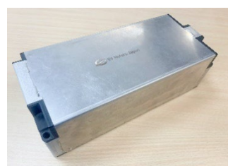
急速充電パックに用いる VDA355 規格のセルとモジュール
