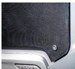
カーボンファイバー高強度複合材料CFRP採用（鉄の5倍の強度）を使用、ディーゼルバスと比較し、車両総重量を低減し、高強度による長期耐用年数と安全性を実現しました。
