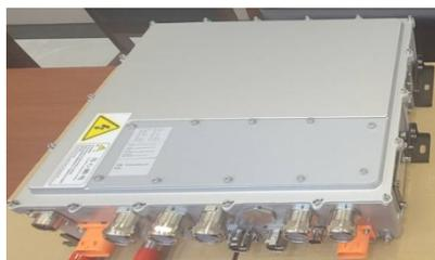
最新の半導体であるSiC(シリコンカーバイド)パワー半導体を採用したアクティブSiCインバータを開発。更なる低電費と長距離の走行を目指します。
