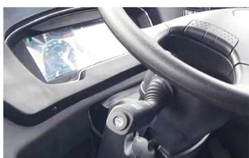
4段階の回生ブレーキを搭載し、減速時に発生するエネルギーを高効率にバッテリーへ回収。フットブレーキを踏まずに減速や停止が可能。アクセルワークだけで運転でき、運転が楽になる。また、フットブレーキの消耗を防ぐことができ、安全性を高めることができます。
