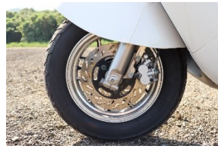
全輪ディスクブレーキ フロント:シングル リア:シングル×2
